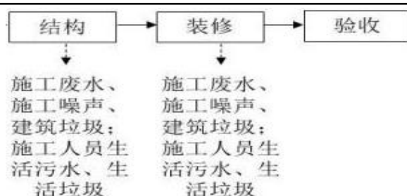
图 2-2 施工期工艺流程及产排污节点示意图
